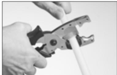
Entfernen Sie eventuelle Späne und scharfe Kanten mithilfe eines geeigneten Entgratungswerkzeugs von der Außenseite des Rohres. Entgraten Sie das Rohr außerdem von innen. Reinigen Sie die Rohrenden, um sämtliche Späne oder Verunreinigungen zu entfernen – dies trägt dazu bei, Schäden am O-Ring beim Einstecken des Rohrs zu verhindern.
