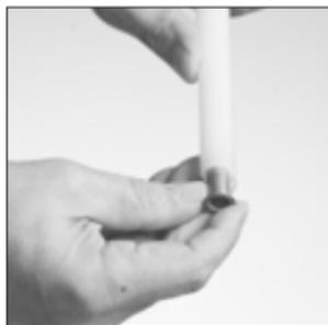
Montieren Sie Überwurfmutter, Schneidring und Kugelhahn.
