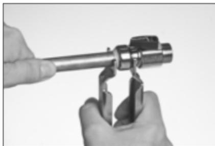
Drücken Sie das Demontagewerkzeug mit einer Hand zusammen, bis der Demontagering in den Fittings zusammengedrückt wird. Drehen Sie das Rohr mit der anderen Hand heraus.
