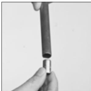
Montieren Sie Überwurfmutter, Schneidring und Fitting.
