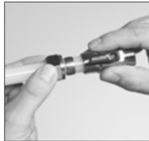
Die Überwurfmutter wird zunächst mit der Hand angezogen und dann mit dem Schlüssel so häufig gespannt, wie in der Tabelle angegeben.
