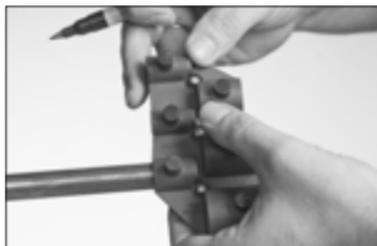
Tectite-Steckverbindungen – Einstecktiefe für
